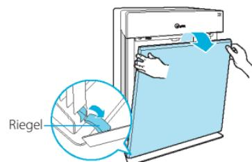
**② Nehmen Sie die Filter aus dem Gerät heraus: Sie sind durch eine Plastikfolie geschützt.**
