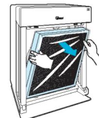
**③ Entfernen Sie die Plastikfolie von den Filtern.**
