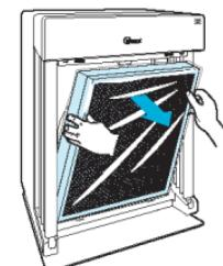
**③ Entfernen Sie die Plastikfolie von den Filtern.**
