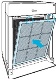
**③ Remettre en place le panneau frontal en commençant par insérer le crochet du bord inférieur dans le socle de l'appareil, puis en retournant le panneau pour que la fermeture magnétique s'effectue dans la partie supérieure de l'appareil.**
