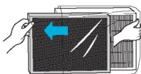
**④ Setzen Sie die Filter so ein, dass sie gut sitzen.**
